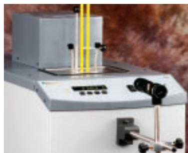
2019-DCBガラス温度計校正用キットには、10本のガラス温度計を取り付けるための保持具と、温度計の読み値の5から15mm以内に液面を引き上げる液体レベル・アダプター・チューブが含まれます。2069拡大スコープの倍率は8倍以上で、各大深度コンパクト・バス本体正面に簡単に取り付けられます。
