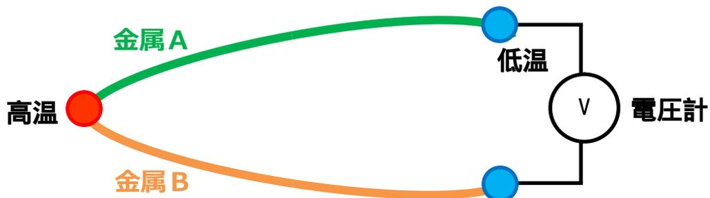
あらかじめ熱電対の種類（2種類の金属線の組合せ）ごとに温度差と熱起電力の関係がわかっているならば、実際の温度計測において計測した熱起電力より温度差が求められます。ここで、低温端（基準接点）の温度を0などに固定できれば高温端（測温接点）の温度が決まります。
